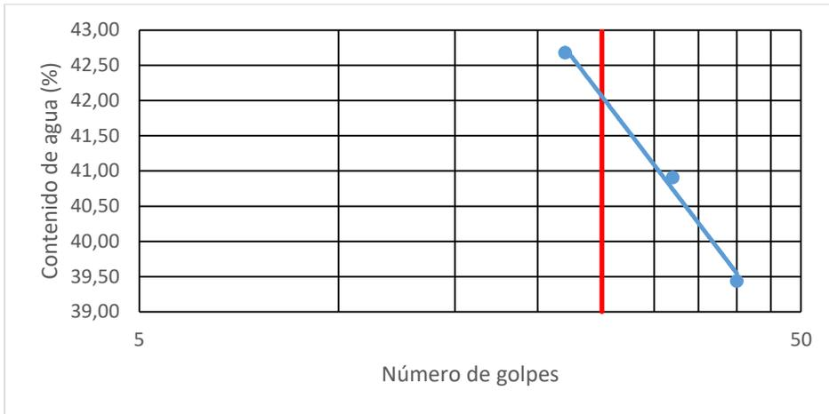
Figura 29. Límite líquido M-2a de extracciones a 1,10 m.
