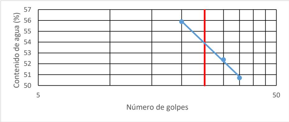
Figura 27. Límite líquido M-1a de extracciones a 1,10 m.
