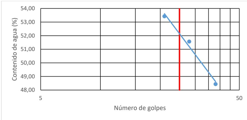
Figura 32. Límite líquido M-3b de extracciones a 2,00 m.
