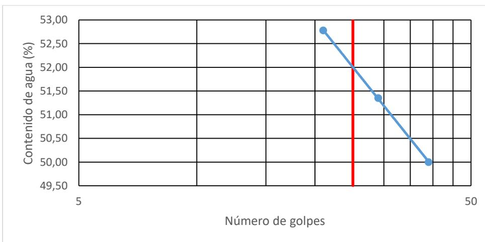
Figura 31. Límite líquido M-3a de extracciones a 1,10 m.
