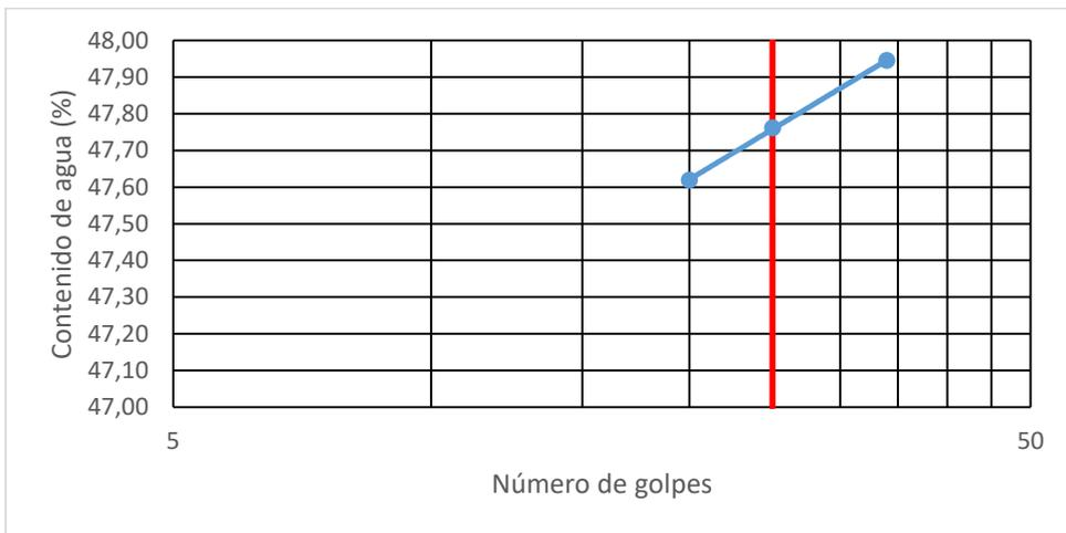
Figura 30. Límite líquido M-2b de extracciones a 2,00 m.
