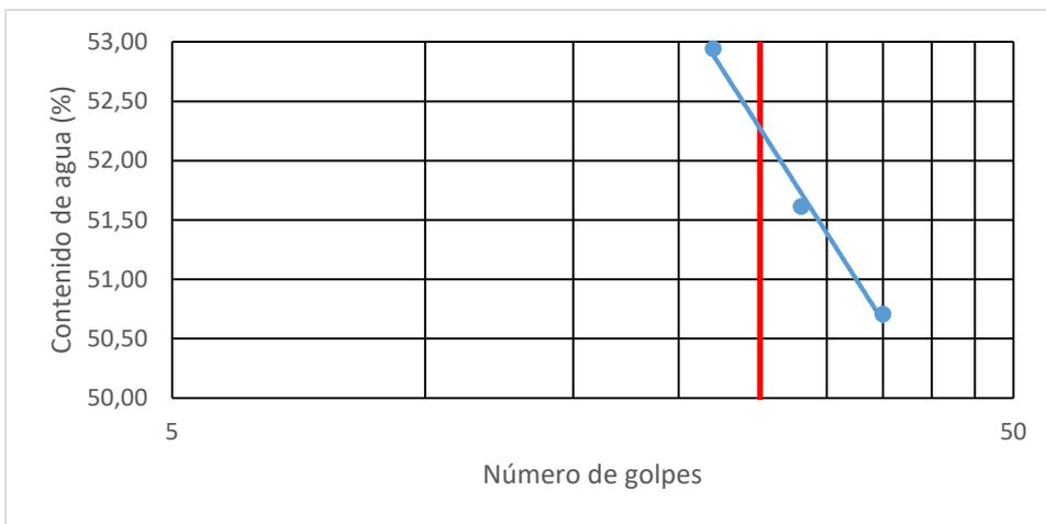
Figura 33. Límite líquido M-4a de extracciones a 1,10 m.
