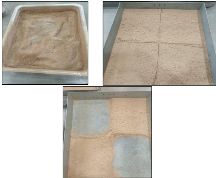
Figura 21. Muestra homogeneizada y cuarteada.
