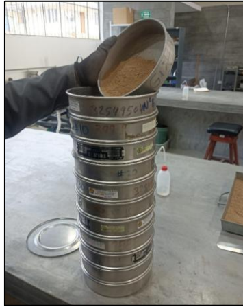
Figura 24. Muestra clasificada a malla #200.
