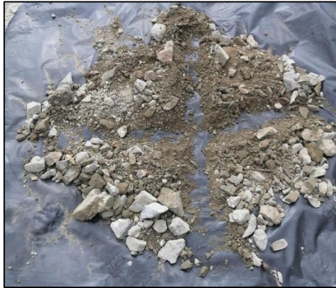
Figura 18. Muestra en fracciones (Cuarteo).
