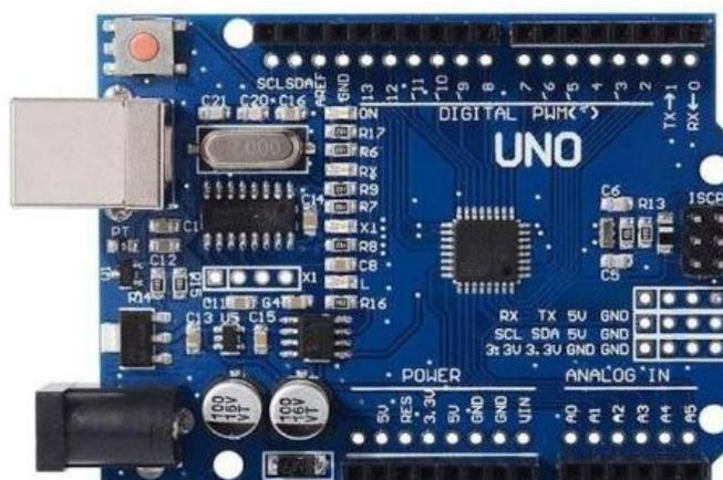
*Figura 26 Placa de desarrollo Arduino UNO R3 SMD (NovatronicEc, 2020)*
