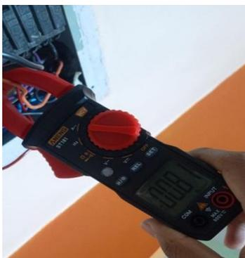
**Figura 71** Intensidad de corriente C2 medida con la pinza amperimétrica ANENG
