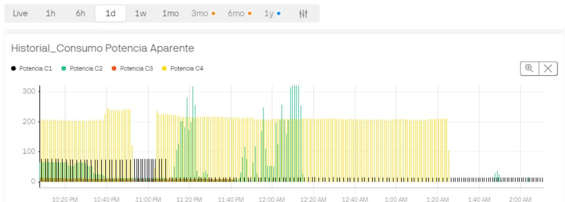
**Figura 60** Potencia aparente consumida de 11AM Y 12AM
