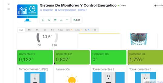
**Figura 70** Intensidad de corriente C1 medida con el sistema de monitoreo
