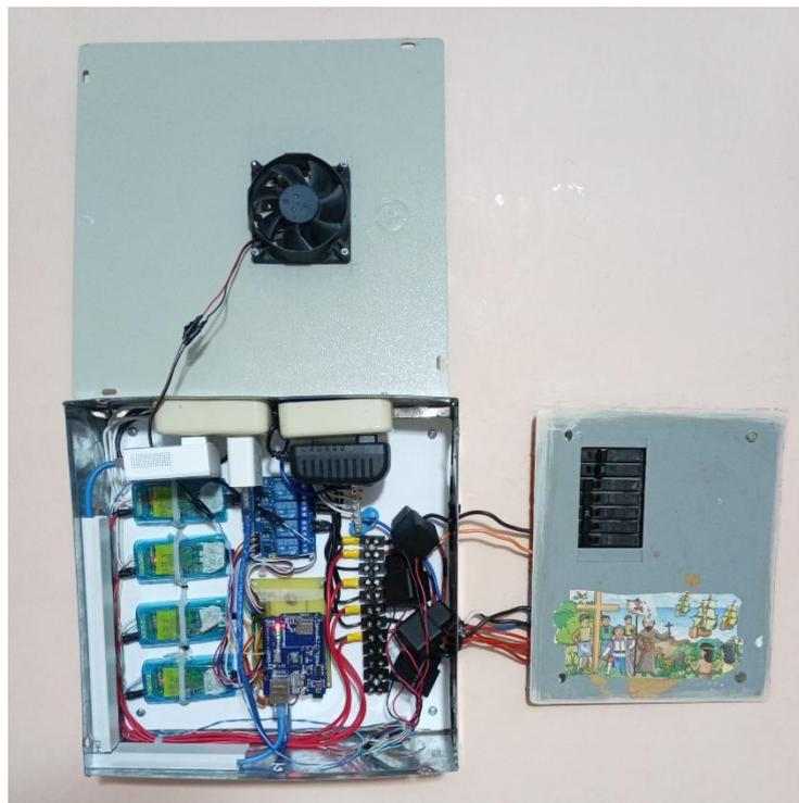
*Figura 44* Tablero de anclaje a la red eléctrica construido, ensamblado e instalado
