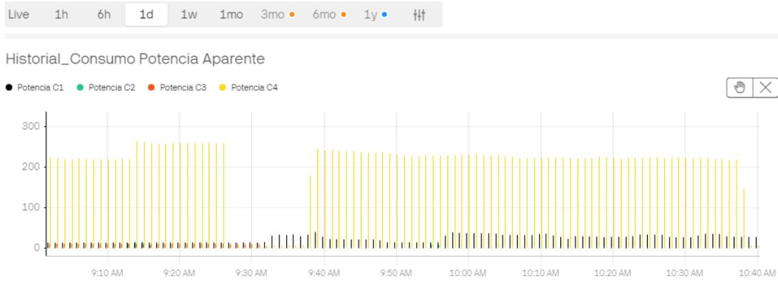
**Figura 57** Potencia aparente consumida de 9AM a 10:40AM
