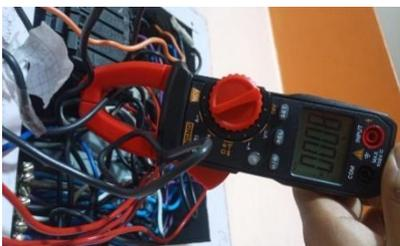
**Figura 73** Intensidad de corriente C3 medida con la pinza amperimétrica ANENG
