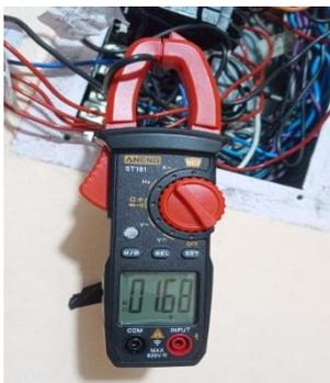
**Figura 76** Intensidad de corriente C4 medida con la pinza amperimétrica ANENG
