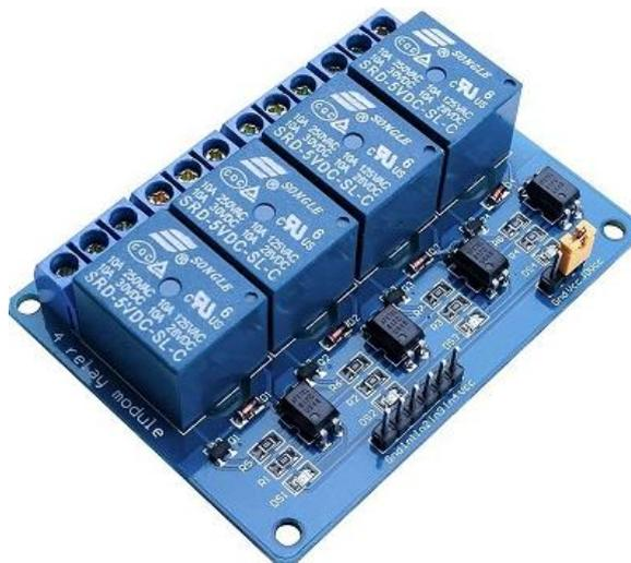
Figura 25 Módulo relé de 4 canales (AV Electronics, 2024)
