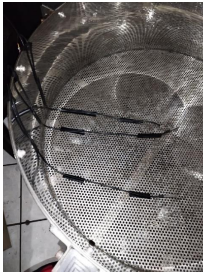
Figura 18: Colocación de los sensores.
