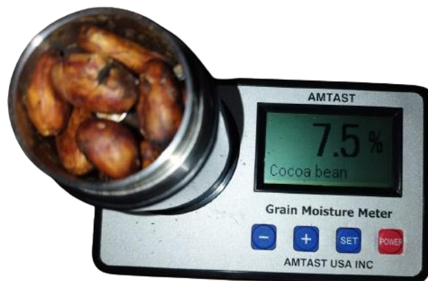
Figura 20: Medición de humedad.
