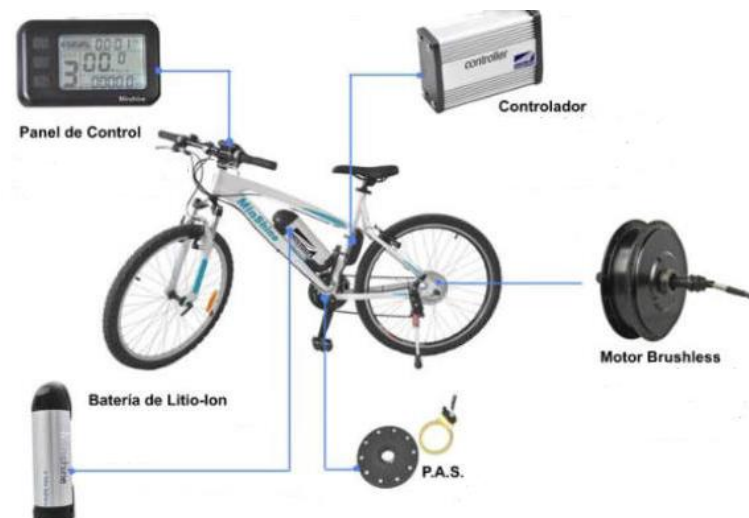
Figura 1. Componentes de una bicicleta
