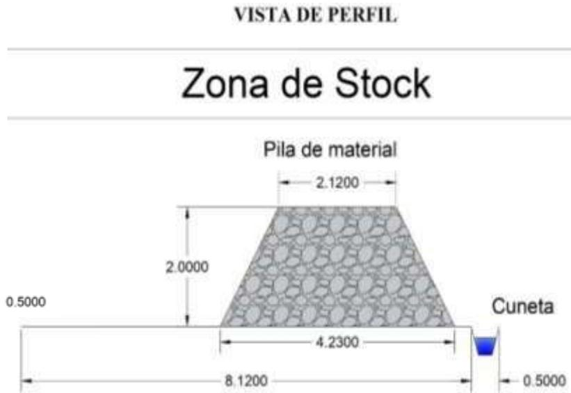
El volumen de material que albergara cada una de las pilas es de 65.66 m<sup>3</sup>, la zona de stock está diseñada para el almacenamiento de 4 pilas y estas al ser simétricas se tendría un stock de 262.67 m<sup>3</sup>.
