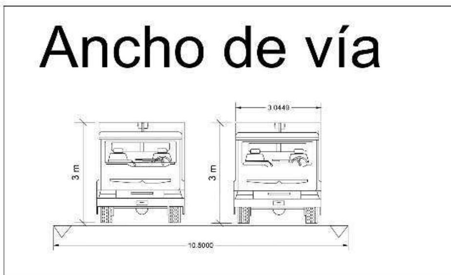
Lo que respecta a las vías fueron ampliadas a 10.5 mts de ancho las mismas que contienen berma de seguridad y cuneta, así mismo, se diseñó una vía que conecte de mejor manera la parte inferior del banco de trabajo con la zona de stock
