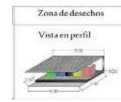
Tiene un área de 45 m<sup>2</sup> con 9 m de frente y 5 m de ancho, posee un encerramiento de malla, techo de zinc y dispondrá de 5 contenedores.
