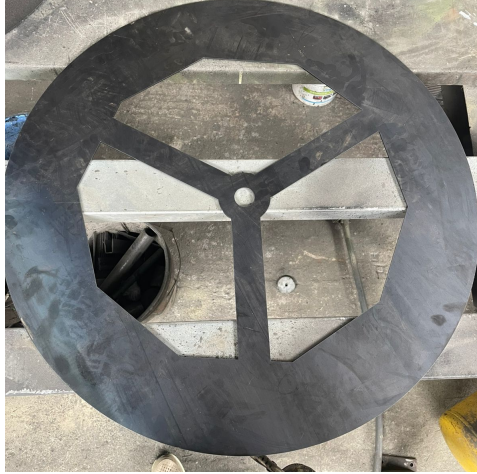
Figura 30. Pieza lateral de rueda hidráulica con cangilones fijos.
