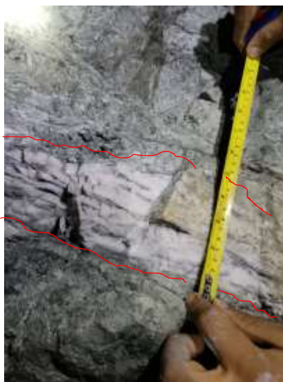
Figura 39. Medición de la potencia de la veta Valentina
