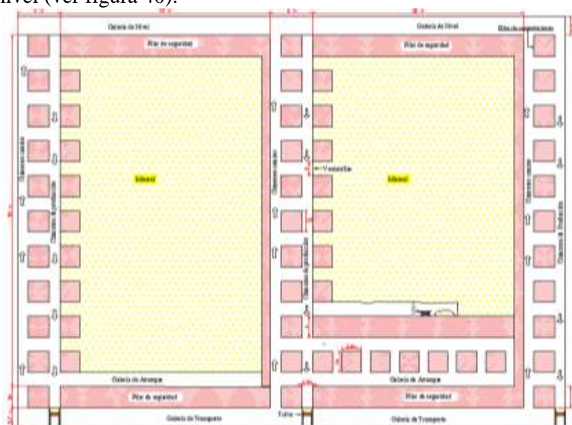
Figura 40. Sistema de Explotación Actual del Bloque 2N
