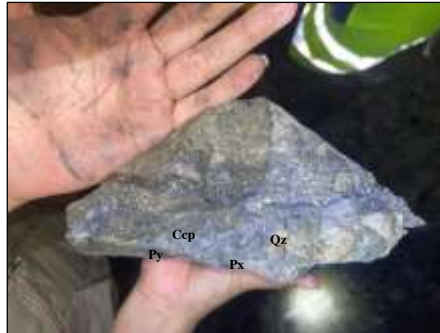
Figura 20. Roca andesítica basáltica con mineralización de Sulfuros (Qz: cuarzo, Py: pirita, Ccp: Calcopirita, Px: Piroxenos).
