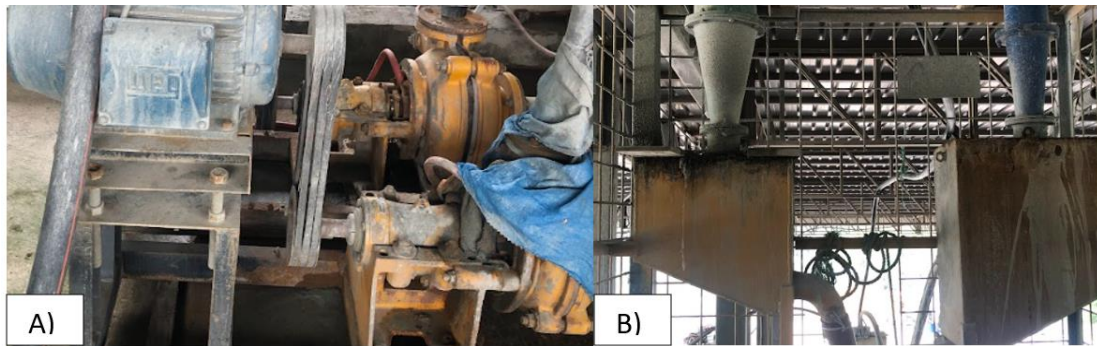
Figura 40: A) Bomba centrífuga de sólidos de 3kW. B) Hidrociclones tipo D6 (verde) y D10 (azul)
