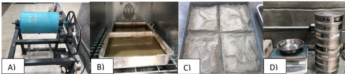
Figura 24: A) Molino a bolas de 11.9'' x 19.37'' (DxL). B) Secado de la pulpa. C) Cuarteo del material molido. D) Tamizado en seco del material fino.
