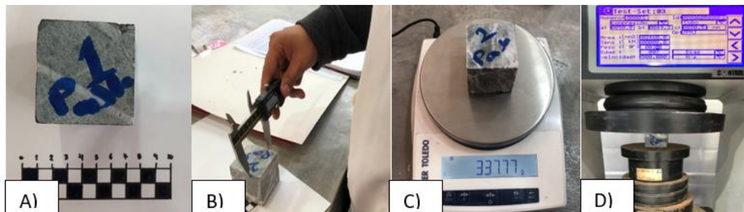
Figura 18: A) Muestra cúbica. B) Medición de la muestra. C) Pesado de la muestra. D) Registro de datos y aplicación del ensayo.
