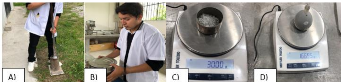
Figura 17: A) Pulverizado de las muestras de roca. B) Tamizado pasante malla #200. C) Colocación de los 30 gramos. D) Peso del picnómetro + agua + material pulverizado
