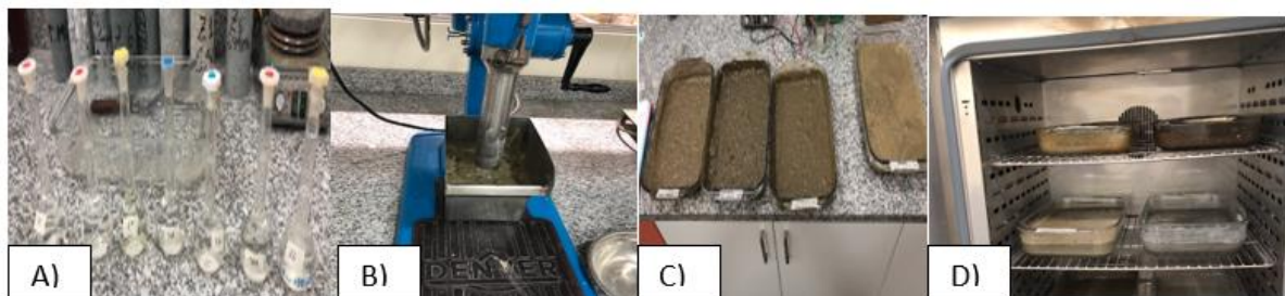
Figura 25: A) Dosificación de reactivos. B) Acondicionamiento y flotación. C) Concentrado y relave. D) Secado del concentrado y del relave.
