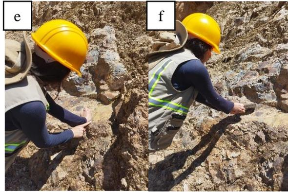
**Figura 30.** Levantamientos de datos de las discontinuidades: **a)** Determinación de línea de escaneo, **b)** Buzamiento y dirección de buzamiento (Brújula Burton), **c)** separación entre juntas, **d)** Longitud de la junta, **e)** Apertura entre juntas, **f)** Rugosidad (peine de Barton)
