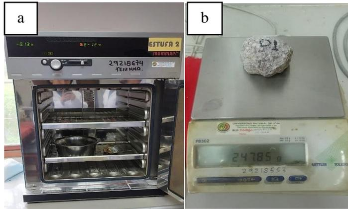
**Figura 27.** a) Muestras puestas por 24 horas en el horno a una temperatura de 105°C, b) Peso seco por cada muestra de roca
