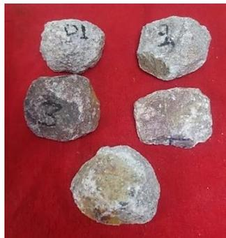
**Figura 24.** Muestras de roca obtenidas para la determinación de los ensayos físicos-mecánicos.
