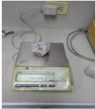
**Figura 25.** Determinación del peso natural por cada muestra de roca
