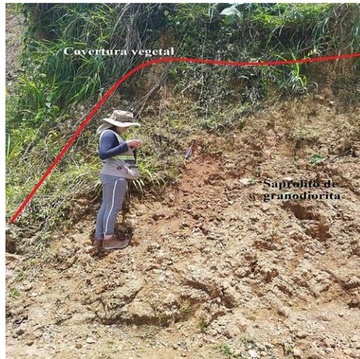
**Figura 36.** Afloramiento de Saprolito de granodiorita
