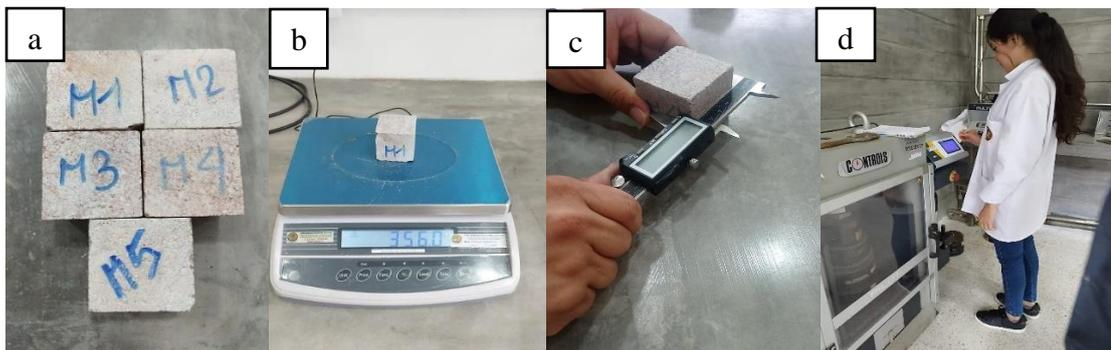
**Figura 29.** Ensayo de compresión simple: a) Obtención de muestras cubicas (5x5x5cm), b) Medida de peso del cubo, c) Medida de alto, ancho y largo del cubo (pie de rey), d) Ingreso de los datos a la prensa hidráulica e inicio del ensayo a la resistencia simple.
