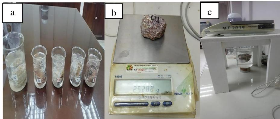
**Figura 26.:** a) Muestras sumergidas por 24 horas en agua destilada, b) Peso saturada por cada muestra de roca, c) Peso sumergido por cada muestra de roca
