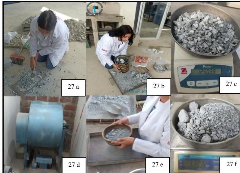
**Figura 27** Secuencia de pasos para el ensayo de abrasividad
