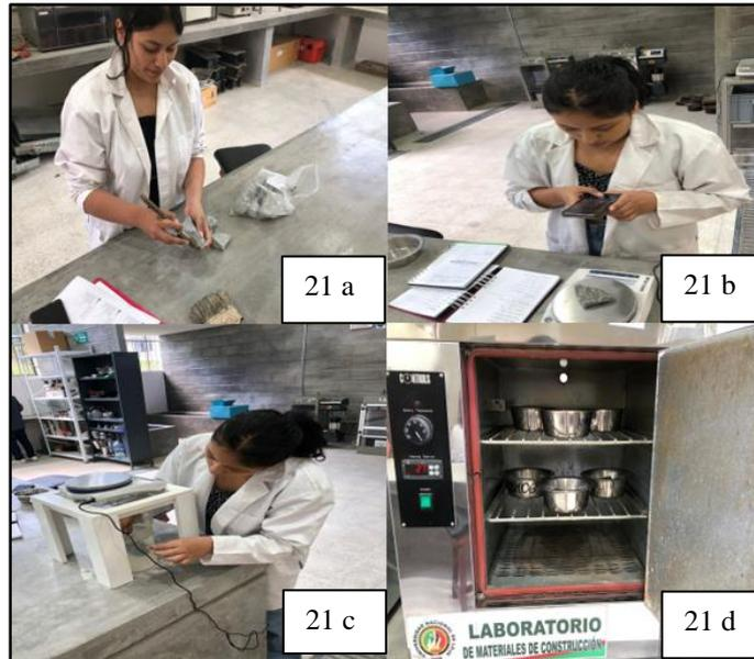
**Figura 21** Secuencia de pasos que se siguió para la obtención de la densidad aparente
