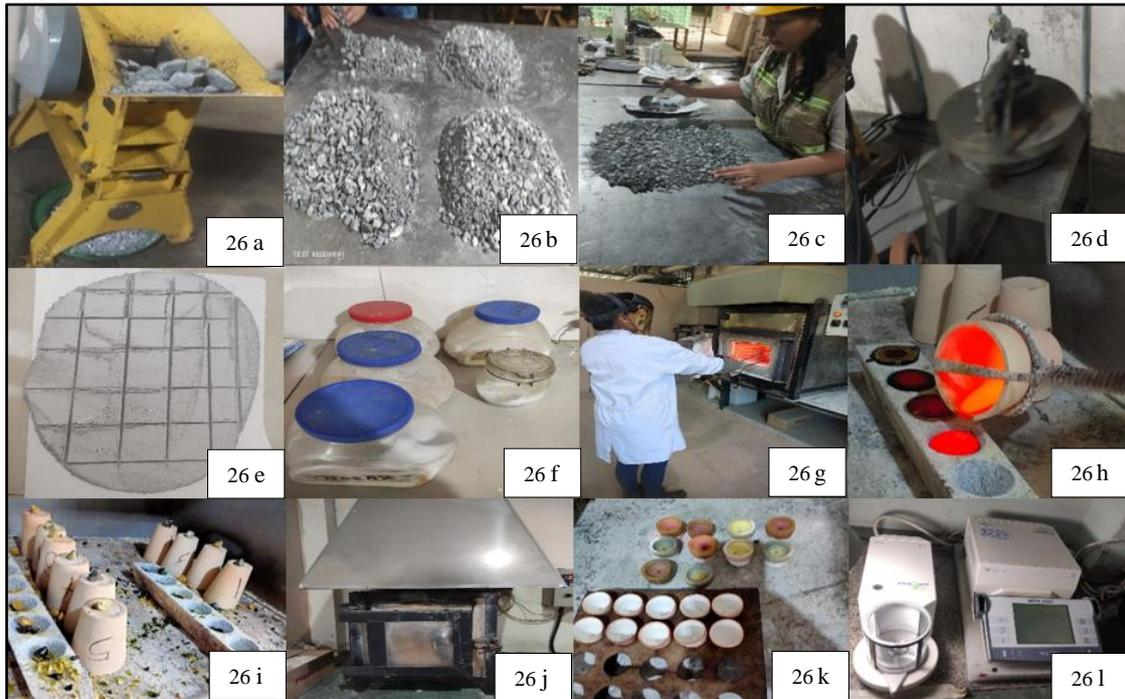
**Figura 26** Procedimiento para la realización del Ensayo al Fuego para ley de Oro (Au)
