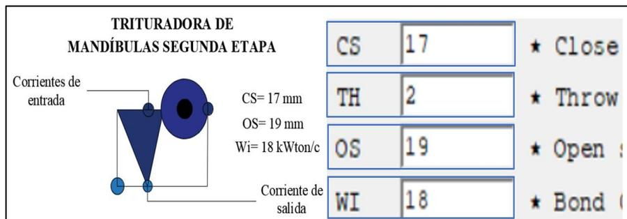
**Figura 41** *Parámetros de diseño para la segunda etapa de trituración*
