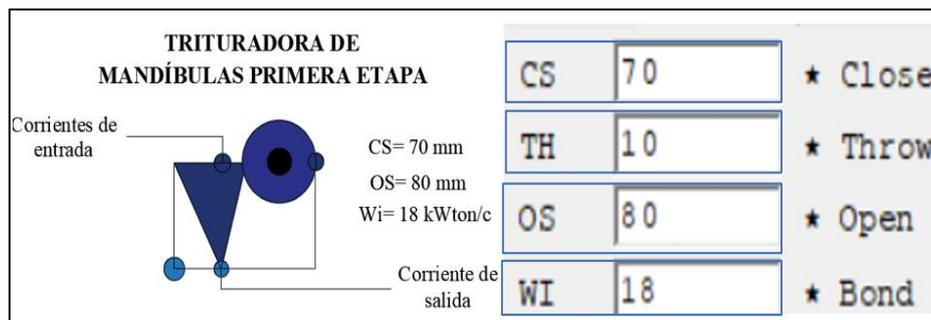
**Figura 40** *Parámetros de diseño para la primera etapa de trituración*
