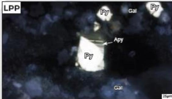
**Descripción:** Se observa un mezcla de cristales de pirita con arsenopirita.
