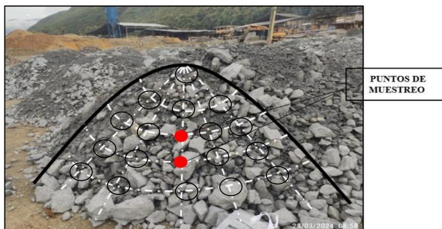
**Figura 18** Muestreo en stock pile
