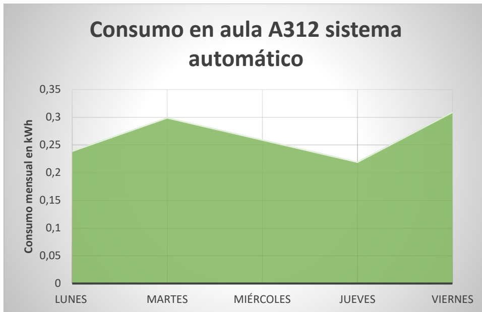
Figura 54. Consumo eléctrico de SCAI medido por equipo Emylo.
