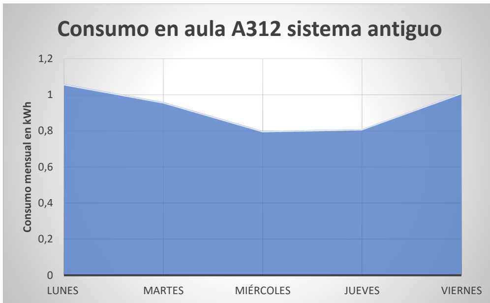
Figura 53. Consumo eléctrico de sistema de iluminación antiguo medido por equipo Emylo.
