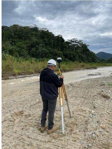
*Nota:* en la imagen se muestra el GPS diferencial ubicado en el punto de partida previo al levantamiento topográfico con ayuda del dron. Fuente: (El Autor, 2022)
