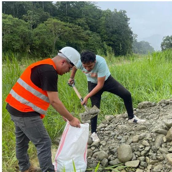
**Figura 15.** *Toma de muestra manualmente del material extraído de las calicatas.* Elaborado por Torres (2022)
