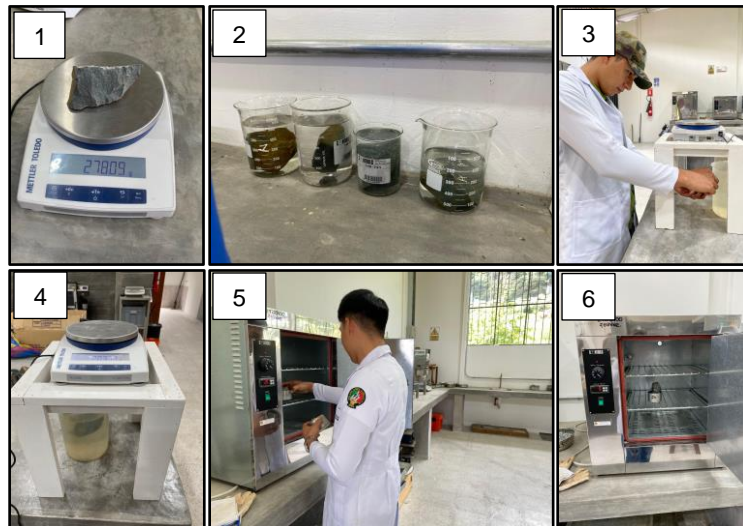
Figura 12. Procedimiento para determinar el peso específico aparente
