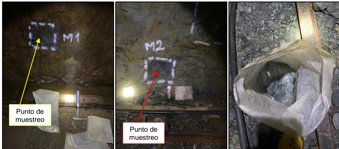
Figura 9. Muestreo para caracterización geológica subterránea
