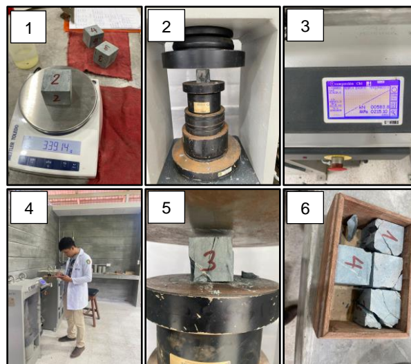
Figura 14. Procedimiento para determinar la resistencia a compresión
