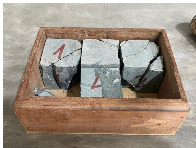
Figura 43. Muestras fracturadas luego del ensayo de compresión simple
