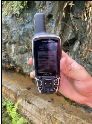
Figura 7. Levantamiento de puntos con GPS Garmin 64xs
