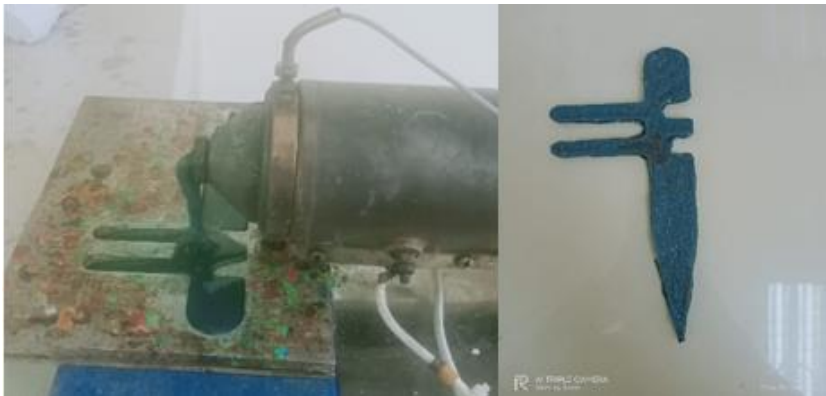
Figura 20. Mezcla del plástico vertida del extrusor al molde
