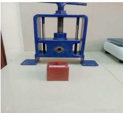
Figura 15. Molde y diseño para prototipos de bloques
