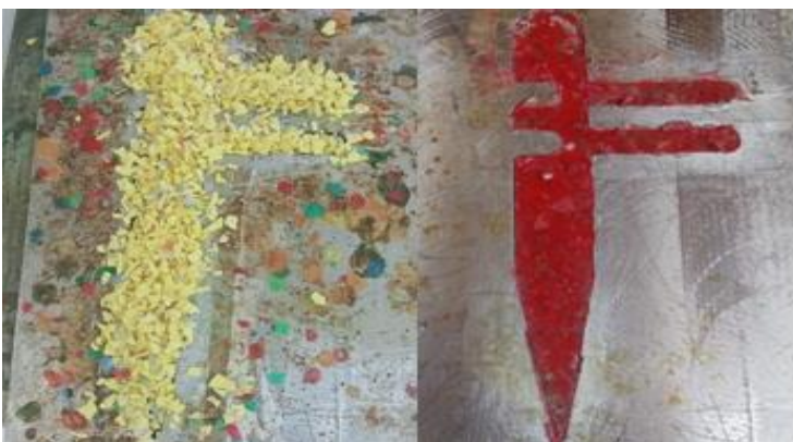
Figura 21. Plástico triturado puesto en molde
