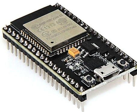
**Figura 3.** ESP32 NodeMCU 32S. Fuente: HiLetgo
