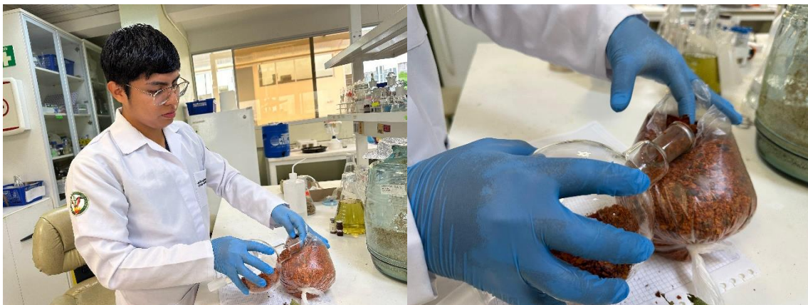
Anexo 7. Colocación de la muestra en el matraz de biomasa.
