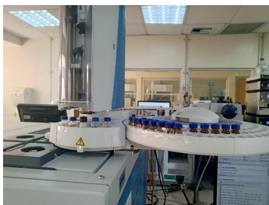
Anexo 14. Inyección de las muestras en el cromatógrafo.
