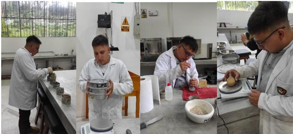
**Figura 9.** Ensayo del peso específico real
