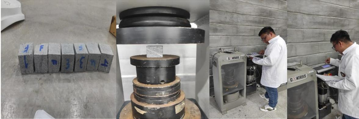
**Figura 10.** Ensayo de resistencia de compresión simple
