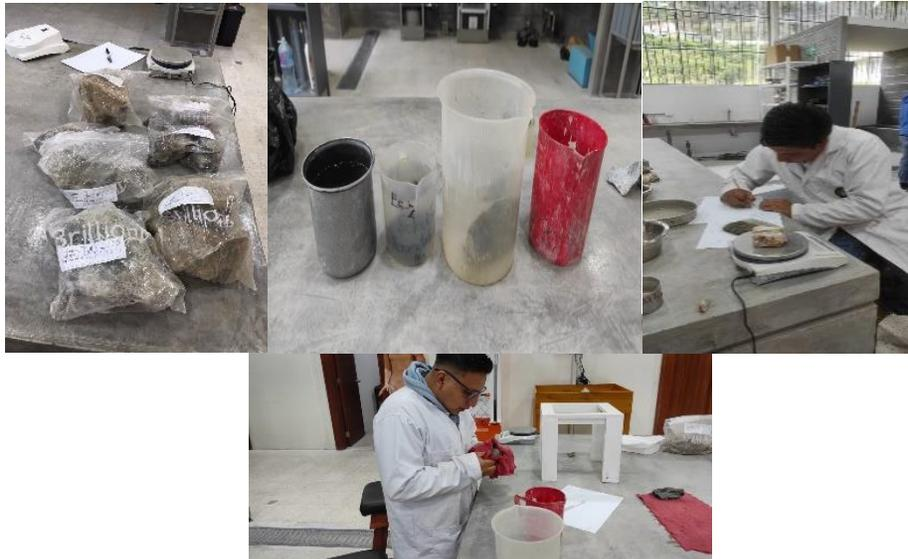
**Figura 8.** Ensayo del peso específico aparente.
