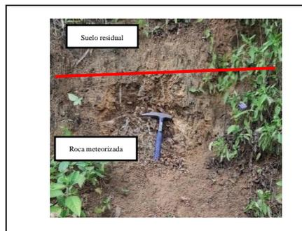
**Figura 24.** Análisis del afloramiento 6 superficial en la mina “El Faique”.
