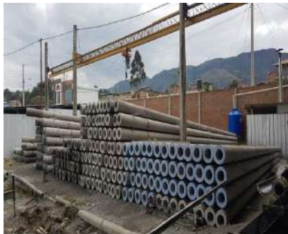
Área de curado y almacenamiento de postes de hormigón.
