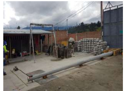
Área de ensayos. Banco de pruebas de postes de hormigón.
