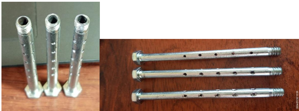
Figura 26. Tubos de refrigeración con sus respectivos orificios de refrigeración y ángulos de dispersión.
