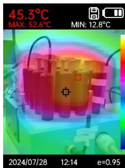
Figura 30. Calibración de temperatura de trabajo mediante cámara termográfica.
