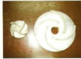
Fig11 Construcción de rodetes
