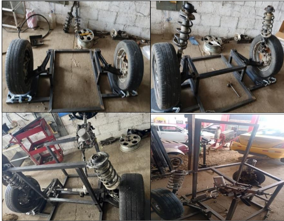
Figura 49. Construcción del Banco de Pruebas
