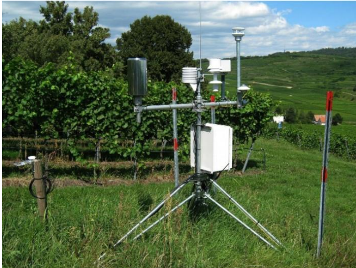
Figura 4. Sensor de precipitación instalado en campo.
