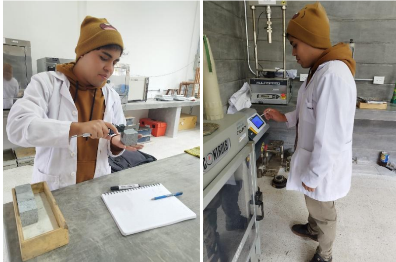
Figura 23. Ensayo de compresión en prensa hidráulica
