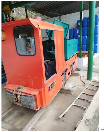
Figura 28. Locomotora eléctrica a batería CT Y5/6G
