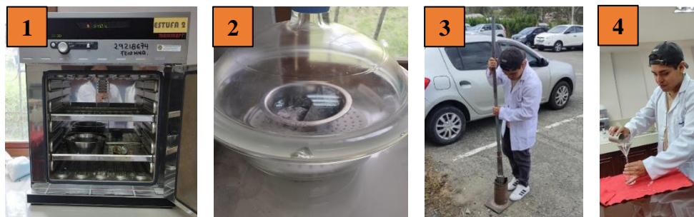
Figura 22. Procedimiento para determinar el Peso específico
