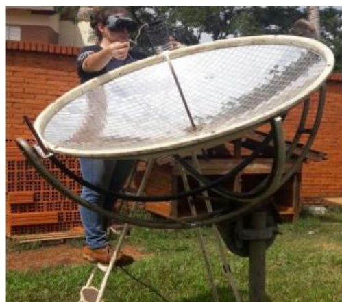
Figura 20. Concentrador solar con espejos como material reflectante.
