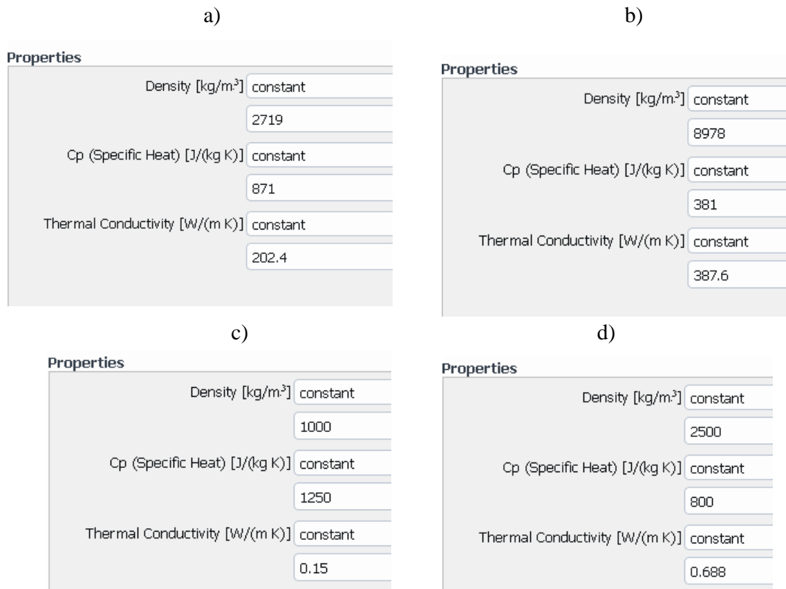
Figura 43. Propiedades físicas y térmicas de los sólidos. (a) Aluminio. (b) Cobre. (c) Plástico. (d) Vidrio.
