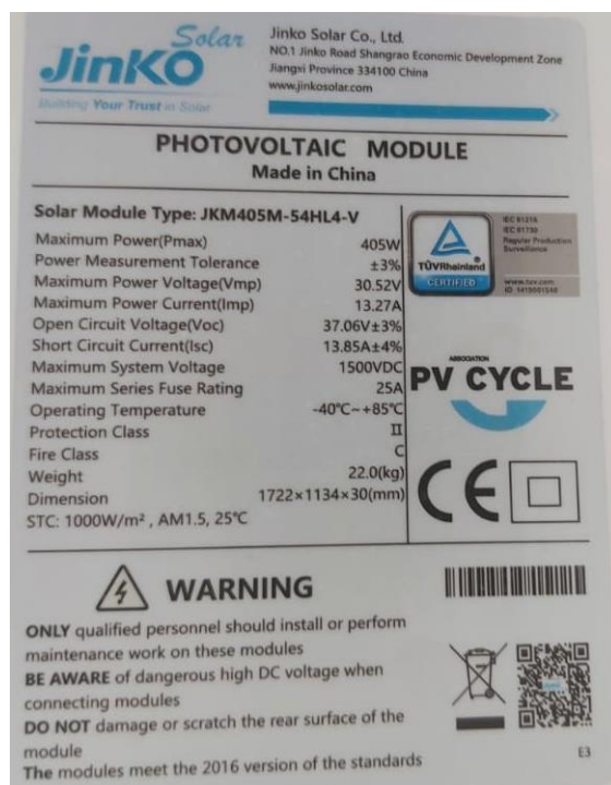
Figura 21. Características panel fotovoltaico. Fuente: Jinko Solar
