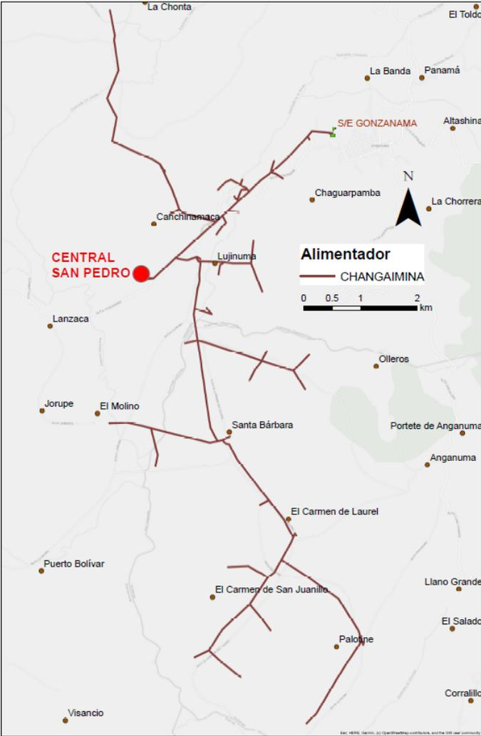
**Figura 7.** Alimentador primario a 13,8 kV Changaimina
