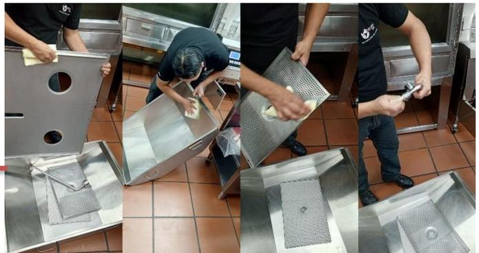
Con un limpión nuevo de color amarillo secar toda la superficie del tanque de filtrado, para evitar existan restos de humedad.
