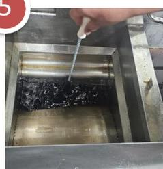
Utilice el cepillo viente para asegurarse que el conducto de drenado no se tapone y lave con este mismo la parte baja de la olla de cocción
