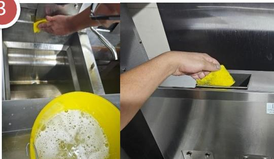
3 Con la válvula de drenado abierta en su totalidad. Utilizando un vileda y solución desengrasante lavar completamente la olla de cocción, chimeneas
