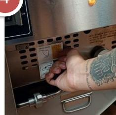
Abra las 3/4 partes de la válvula de drenaje y drene todo el aceite en el tanque de filtrado. Siga limpiando con el cepillo mientras baja el aceite
