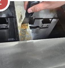
Con la ayuda de una espátula retire los residuos de cracking de la olla de cocción.
