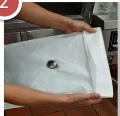
Realizar un doblé en la parte superior del filtro de pellón con dirección al lado del agujero de los filtros
