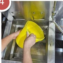
5 Utilizando un limpión amarillo y solución sanitizante sanitizar completamente la olla de filtrado
