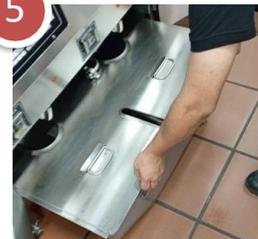
Tapar el tanque haciendo que el tubo de succión se ubique en la apertura de la tapa e insertamos el tanque en la máquina
