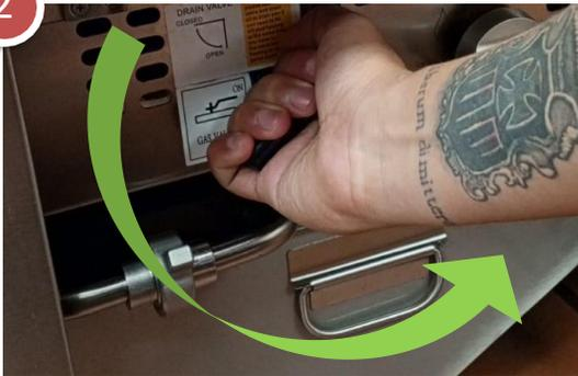
Apague el equipo y abra la válvula de drenado en las 3/4 partes y deje drenar el aceite hasta la mitad
