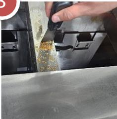
Con la ayuda de una espátula retire los residuos de cracking de la olla de cocción.
