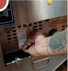
Abra las 3/4 partes de la válvula de drenaje y drene todo el aceite en el tanque de filtrado. Siga limpiando con el cepillo mientras baja el aceite
