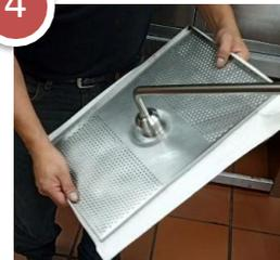
Atornillar el tubo de succión y colocar el filtro armado en el tanque de filtrado
