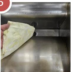
6 Con un limpión amarillo, nuevo secar totalmente la olla de filtrado para evitar que queden residuos de humedad
