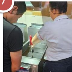
8 Cierre la válvula de drenado y presione Pump, hasta que el aceite suba en su totalidad. Apague por completo la máquina.
