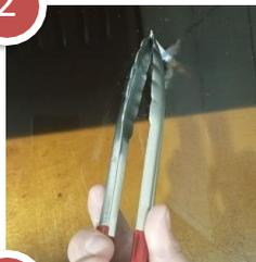
Tomamos la tirilla con una pinza y sumergimos en el aceite en temperatura DROP hasta la marca indicada, durante 5 segundos
