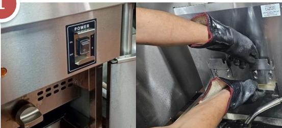
Apague el equipo para comenzar con la limpieza de la olla de cocción. Retire la canasta sujetadora y parrillas metálicas, utilizando los guantes negros.
