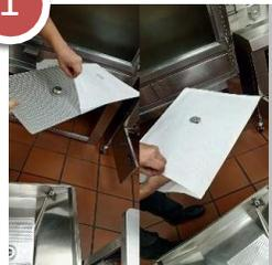
Introducir el filtro metálico en un filtro de pellón de manera que el agujero de los dos se encuentre alineado
