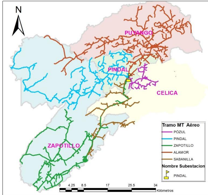
Figura 10. Alimentadores de la subestación Pindal.
