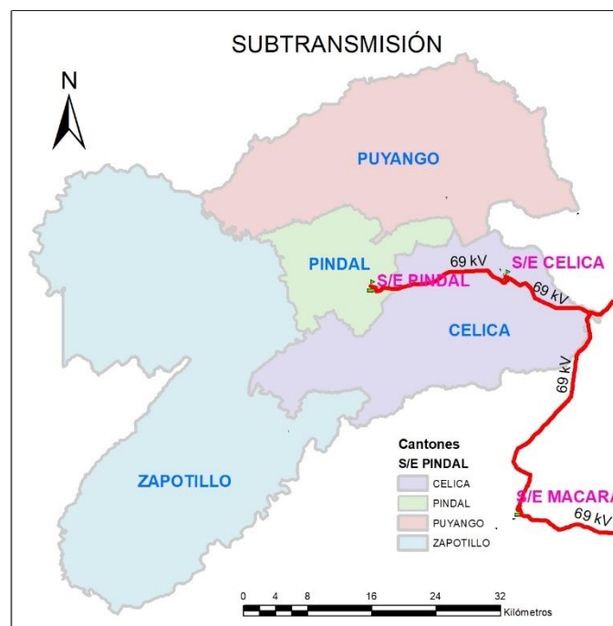
Figura 9. Suministro a 69 kV de la subestación Celica y Pindal.
