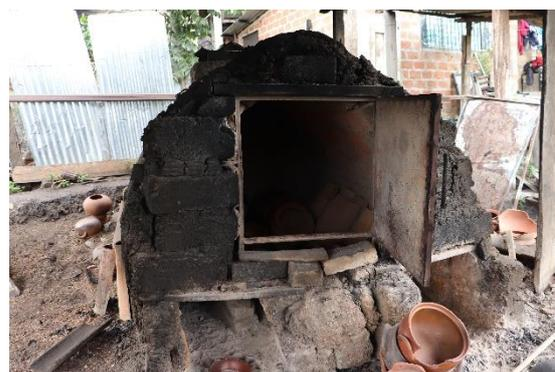
**Figura 14.** Horno para el quemado de las piezas de barro
