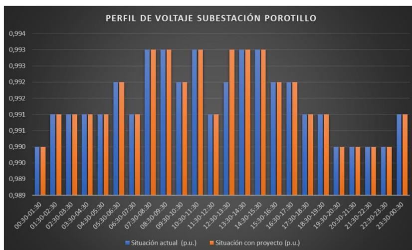
**Figura 24:** Variación horaria del perfil de voltaje en barra de 69 kV de la subestación Porotillo.
