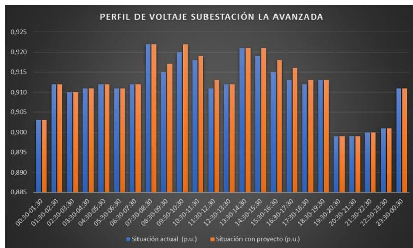
**Figura 23:** Variación horaria del perfil de voltaje en barra de 69 kV de la subestación La Avanzada.
