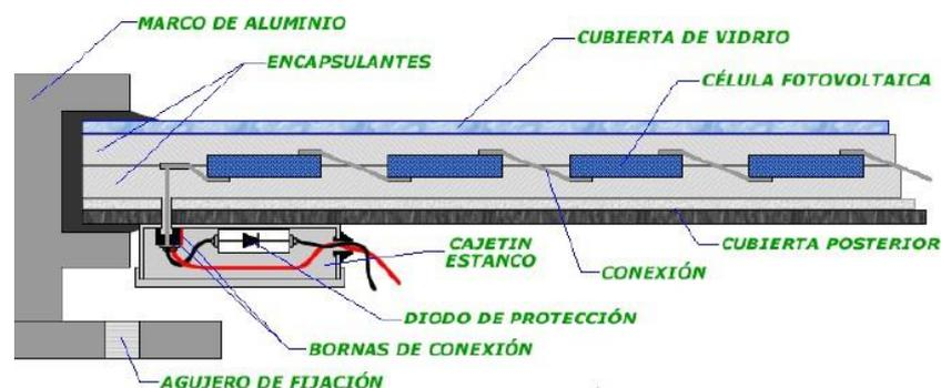
**Figura 8:** Estructura típica de un módulo FV
