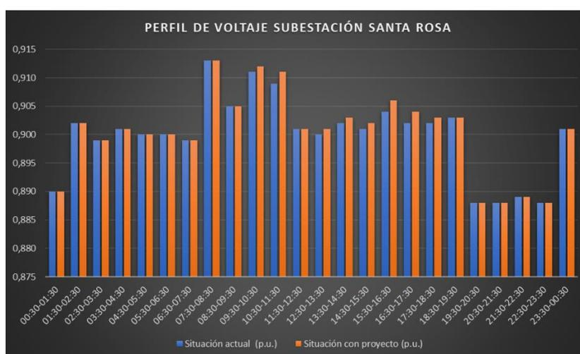
**Figura 25:** Variación horaria del perfil de voltaje en barra de 69 kV de la subestación Santa Rosa.
