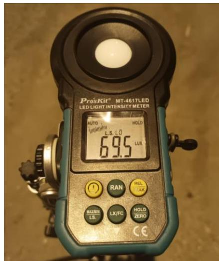
**Figura 29.** Luxómetro empleado para las mediciones.
