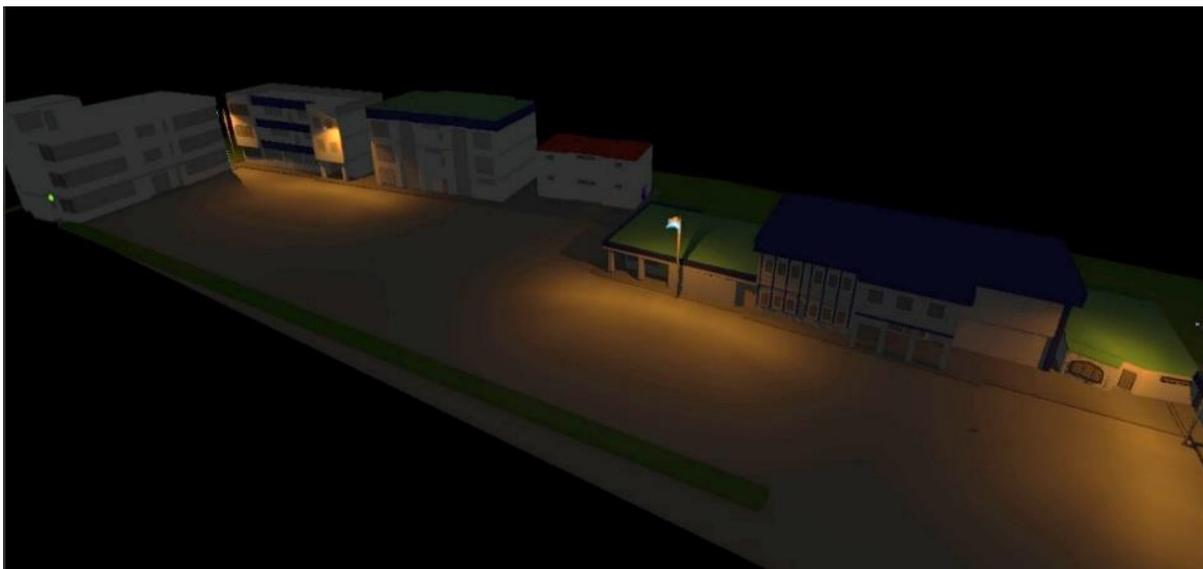
**Figura 44.** Simulación del sistema actual de iluminación del área de parqueaderos.
