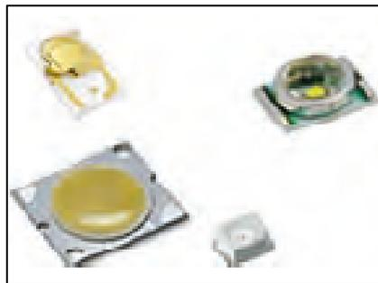
**Figura 22.** Diodos led modernos.
