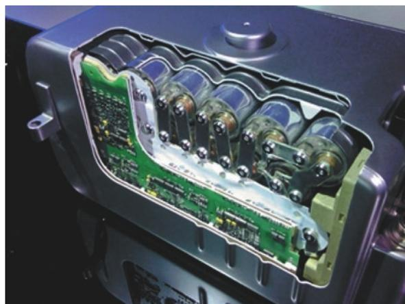
**Figura 4.** Sistema de batería de iones de litio con diseño de bloque, Daimler S400 híbrido (cortesía de Daimler AG).
