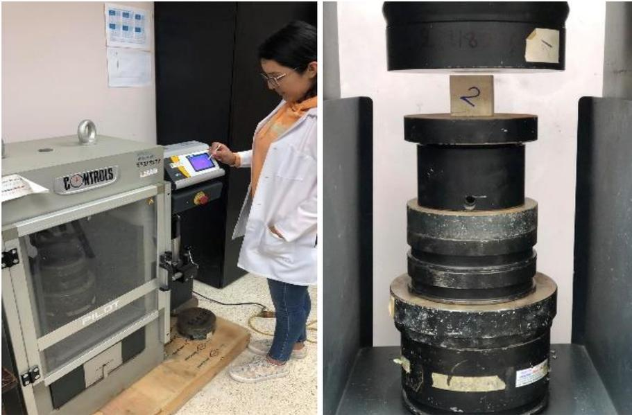
**Fotografía 4.** Ejecución del Ensayo de Compresión Simple
