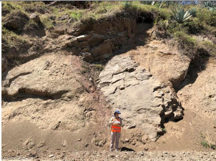
**Descripción litológica:** Afloramiento antrópico constituido por un aglomerado volcánico con tobas andesíticas con presencia de vetillas carbonatos de calcio, se observa minerales como cuarzo y hematita; además, se encuentra algo meteorizada en la parte baja.
