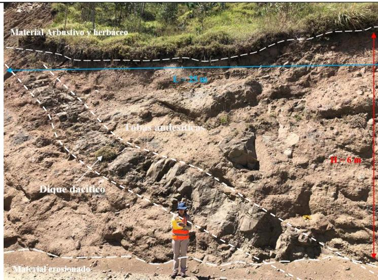
**Descripción litológica:** Afloramiento antrópico constituido por un aglomerado volcánico con tobas andesíticas; además, se encuentra algo meteorizada en la parte baja donde se observó material disgregado. Se evidenció la existencia de una intrusión de un dique dacítico inclinado con un espesor de 1.3 cm. La capa vegetal medio lo constituían el material arbustivo y herbáceo con una potencia de hasta 60 cm.
