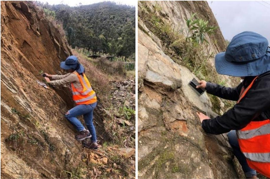
**Fotografía 2.** Datos geomecánicos, medida buzamiento y medida de rugosidad con peine de barton.
