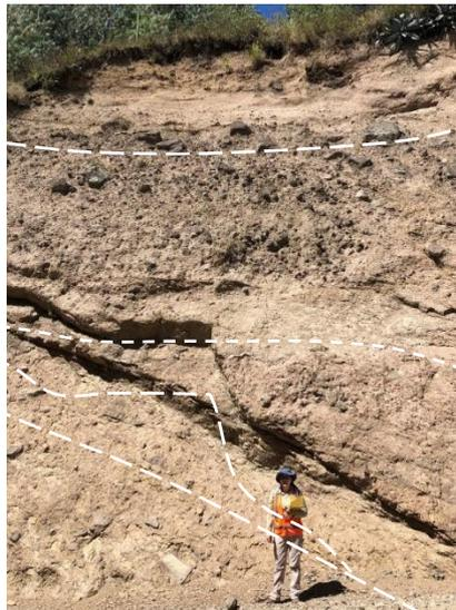
**Descripción litológica:** Afloramiento antrópico constituido por un aglomerado volcánico con de tobas andesíticas con una orientación preferencial de 326/83 hacia el NW y presencia de planos de debilidad; además, se encuentra algo meteorizada en la parte baja donde se observó material disgregado. La capa vegetal medio lo constituían el material arbustivo y herbáceo con una potencia de hasta 60 cm.
