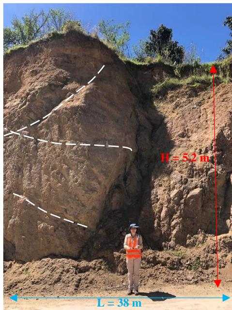
**Descripción litológica:** Afloramiento antrópico constituido por un aglomerado volcánico con tobas andesíticas en una matriz de grano fino, se evidenció además la presencia de planos de debilidad y cárcavas a lo largo de todo el talud. Posee un grado de meteorización alta, en la zona baja se observó material disgregado. La cobertura vegetal tiene una potencia de hasta 20 cm.
