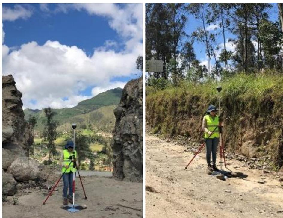
**Fotografía 1. Medición de los Puntos Fotogramétricos**
