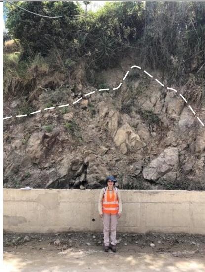
**Descripción litológica:** Afloramiento antrópico constituido por tobas andesíticas con presencia de láminas carbonatos de calcio se encuentra muy meteorizada. En la base se observó en la base del talud una disgregación del material en partículas más pequeñas debido a la acción meteorológica. La capa vegetal es abundante tipo arbustivo y herbáceo con una potencia de hasta 80 cm.
