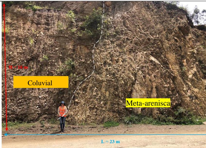
**Descripción litológica:** Afloramiento antrópico en el que se evidencia un contacto entre una met-arenisca bien compacta y el coluvial polimítico, lo que podría indicar que el sitio fue un antiguo lecho fluvial (paleocauce). El depósito coluvial está constituido por cuarcitas, esquistos en clasto soportados en una matriz arenosa. Se encuentra afectado medianamente por la meteorización y no hay indicios de humedad.
