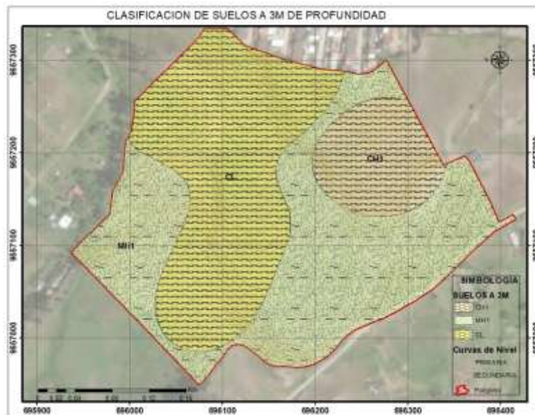
Figura 95. Clasificación de suelos a 3m de profundidad. Nota. Ruiz Escovar (2023)
