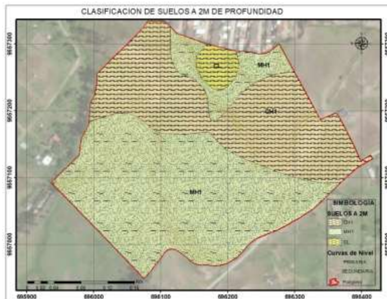
Figura 94. Clasificación de suelos a 2m de profundidad. Nota. Ruiz Escovar (2023)
