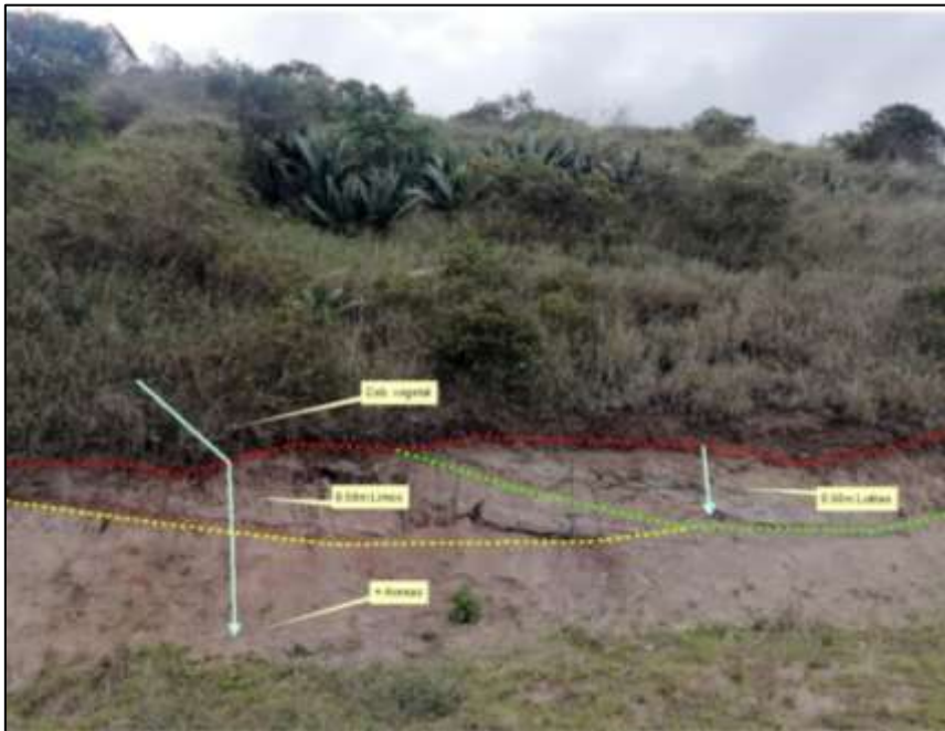
Figura 36. Afloramiento zona de estudio presencia de limos y areniscas. Nota. Ruiz Escovar (2023)
