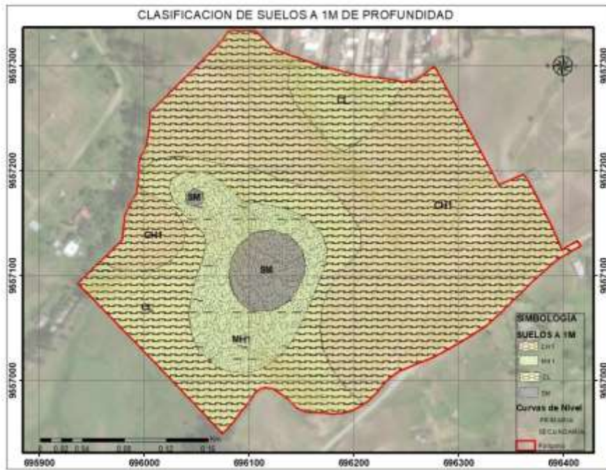
Figura 93. Clasificación de suelos a 1m de profundidad. Nota. Ruiz Escovar (2023)
