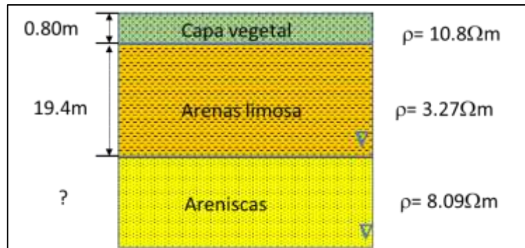
Figura 73. Corte geoelectrico SEV 4. Nota. Ruiz Escovar (2023)
