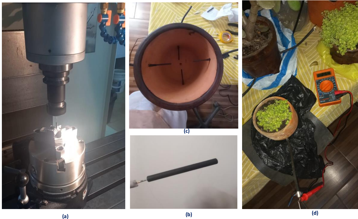
Electrodo de varilla de carbono con cable coaxial
