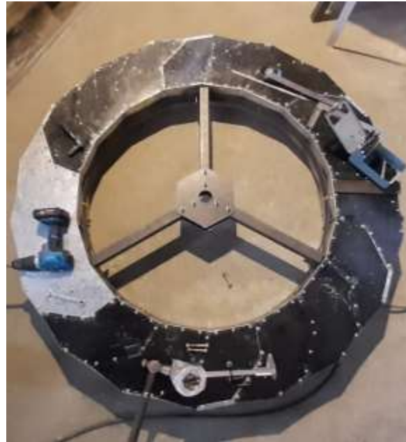
Figura 59. Rueda hidráulica y herramientas usadas para su montaje.
