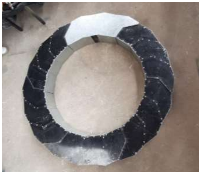
Figura 54. Armado final de los cangilones.
