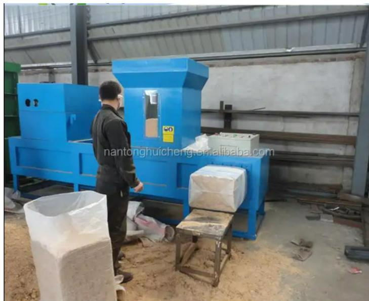
**Figura 8.** Máquina Empacadora de cascarilla de arroz (Rugao Huicheng Hydraulic Machinery Co., 2013).
