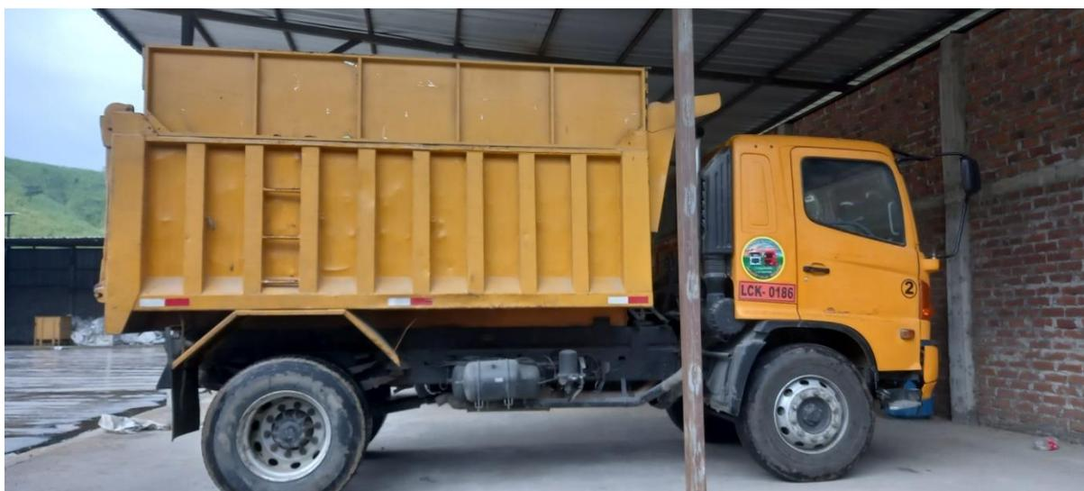
**Figura 7.** Volquete para transportar arroz a granel
