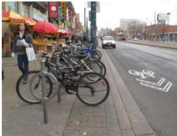
**Figura 7.** Estacionamiento tipo "Post and Loop"
