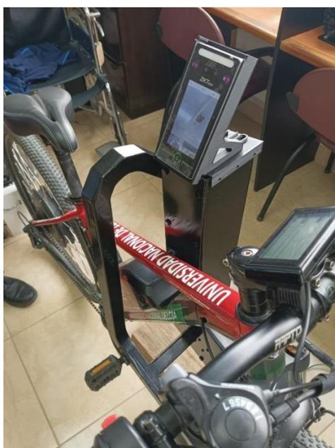
**Figura 41.** Propuesta 2 para ubicación del equipo biométrico
