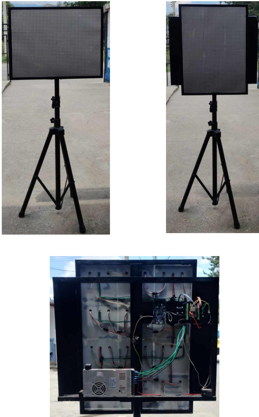
Figura 41. Prototipo de pantalla informativa construido. Presentación del formato horizontal, vertical y parte posterior de la pantalla.
