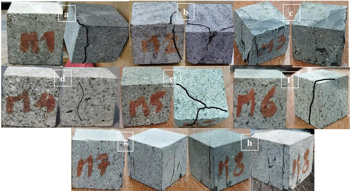
**Figura 52.** Rotura de los cubos de roca a partir del ensayo de compresión simple: **a)** rotura de la muestra 1 de roca, **b)** rotura de la muestra 2 de roca, **c)** rotura de la muestra 3 de roca, **d)** rotura de la muestra 4 de roca, **e)** rotura de la muestra 5 de roca, **f)** rotura de la muestra 6 de roca, **g)** rotura de la muestra 7 de roca, **h)** rotura de la muestra 8 de roca
