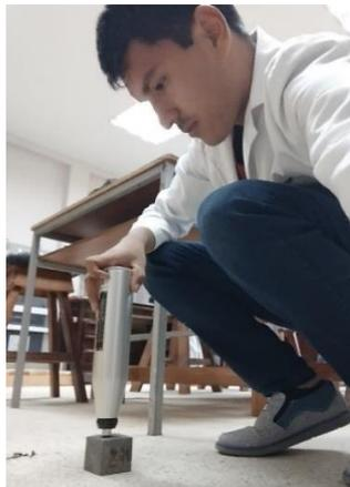
**Figura 15.** Ensayo del rebote al martillo de bajo impacto en junta pulida.
