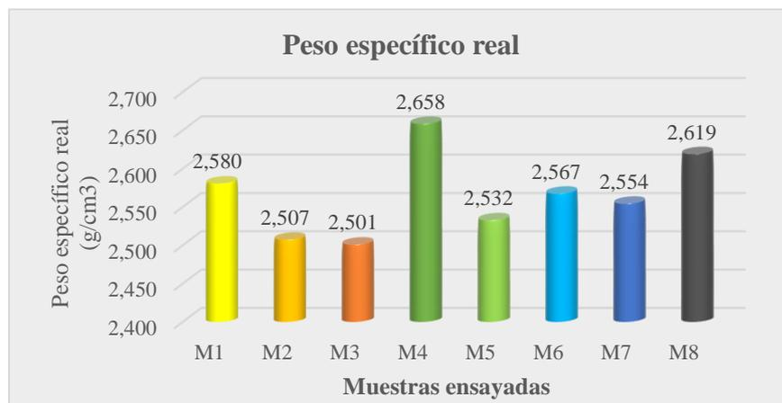
**Figura 45.** Distribución gráfica del peso específico por cada muestra de roca.
