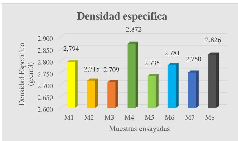
**Figura 50.** Distribución gráfica de la Densidad Específica por cada muestra de roca.
