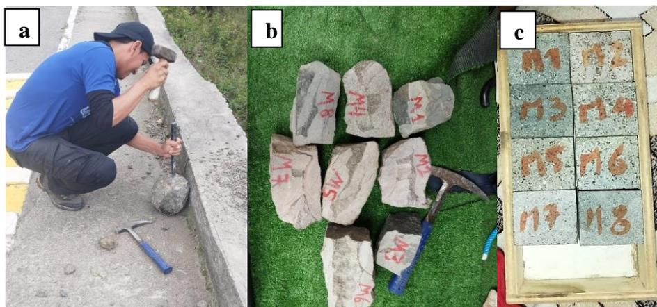
**Figura 14.** Etapa de obtención de cubos 5x5x5 cm: **a)** Obtención ideal de la muestra a través de martillo y cincel, **b)** Codificación de la muestra por zona, **c)** Post proceso de cortado y pulido en cubos de 5x5x5cm.
