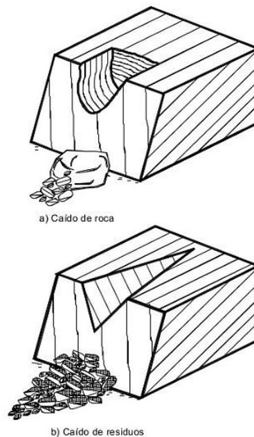
**Figura 1.** Esquema de caído de roca (a) y caído de residuos (b).
