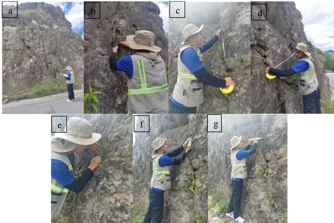
**Figura 13.** Campaña de levantamiento de datos en campo: **a)** Determinación de la línea de escaneo, **b)** Buzamiento y dirección de Buzamiento (Brújula Burton), **c)** Separación entre juntas, **d)** Longitud de la junta, **e)** Apertura entre juntas, **f)** Rugosidad (peine de Barton), **g)** Ensayo de esclerometría hacia la junta natural.
