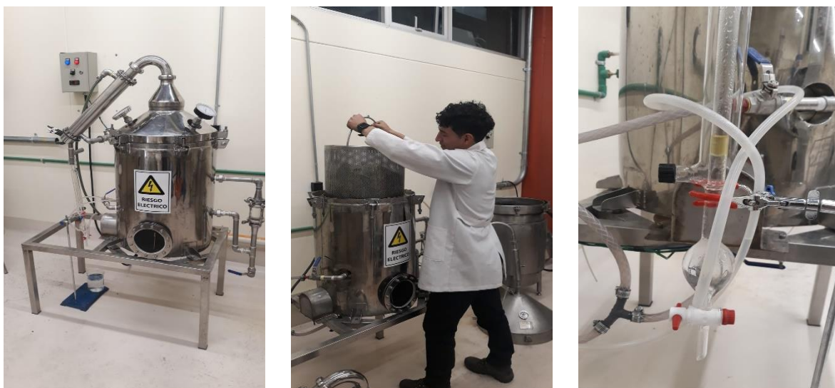
Figura 16. Extracción del aceite esencial de las hojas de E. globulus por arrastre de vapor de agua.
