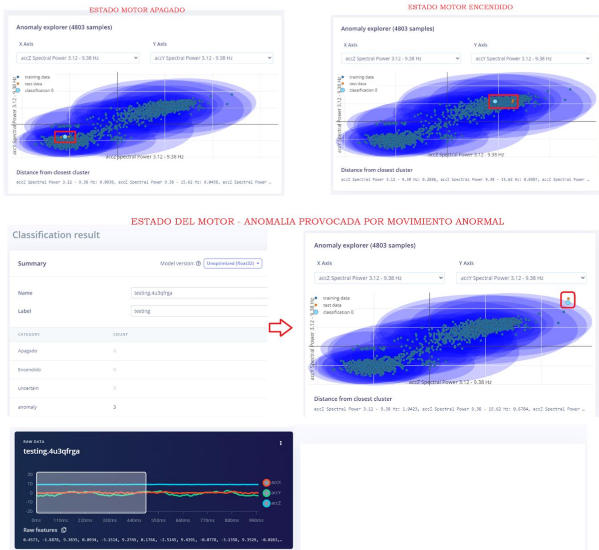
Figura 62. Detección de anomalías en pruebas realizadas en Edge Impulse.
