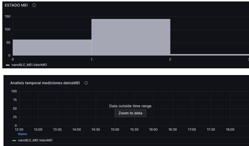
Figura 59. Panel tipo histograma y time series colocados en dashboard en Grafana.
