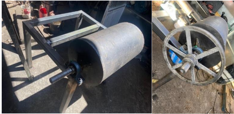
Figura 44. Polea principal y montaje de la cámara de molienda
