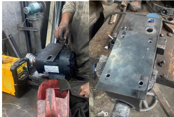
Figura 46. Base del motor y montaje de la polea
