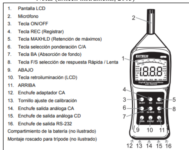
Figura 66. Descripción partes del sonómetro Nota. (Extech instruments, 2013)
