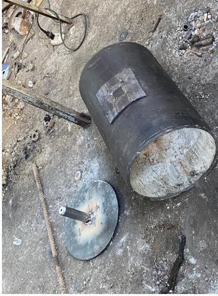
Figura 41. Ejes y cámaras de molienda
