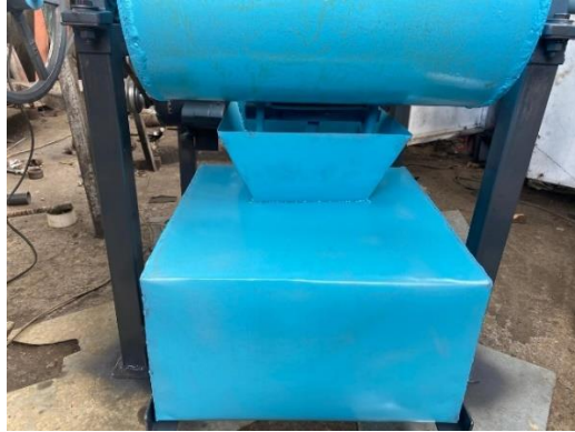
Figura 48. Tolva con bandeja para la caída del material
