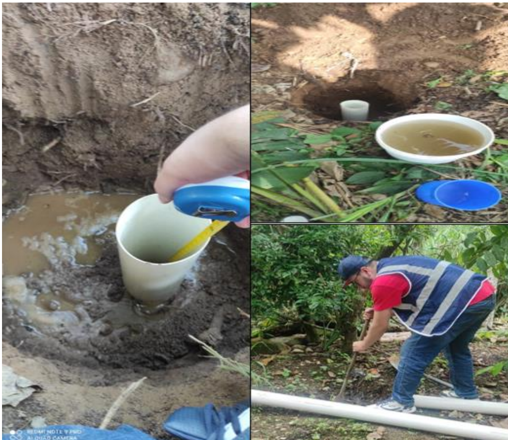
Figura 20. Medición de la permeabilidad In Situ
