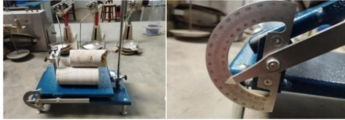
**Figura 31.** Esquema del ensayo tilt test en núcleos de roca
