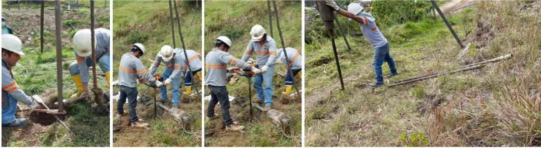
**Figura 21.** *Ensayo de penetración estándar*
