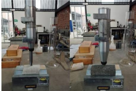
**Figura 29.** Ensayo de rebote del martillo de Schmidt
