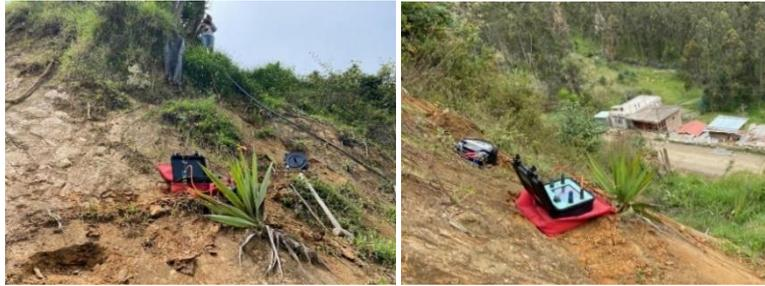
**Figura 19.** *Ensayo de sísmica de refracción*
