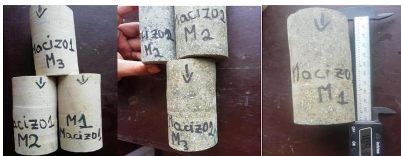
**Figura 27.** Testigos de roca perfilados
