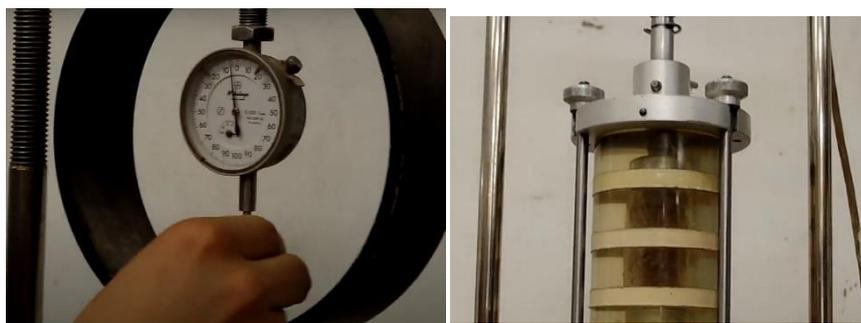
**Figura 25.** Ensayo triaxial no consolidado no drenado
