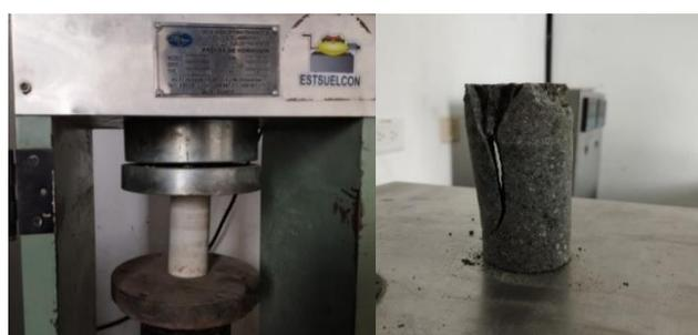
**Figura 28.** Ensayo de resistencia a la compresión simple
