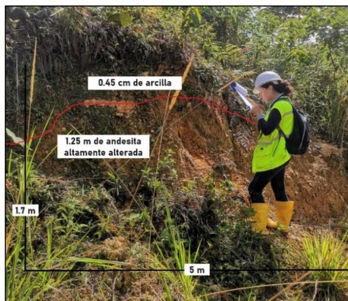
El afloramiento se encuentra completamente húmedo y cubierto por una capa de arcilla de color café claro. En la superficie subyaciendo a la capa vegetal se visualiza una capa de arcilla con un espesor de 0.45 m, siguiente a ella una capa de andesita altamente alterada de textura afanítica de consistencia blanda y porosa con espesor de 0.85 m.
