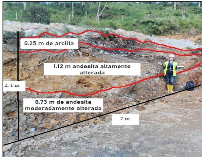
El área se encuentra húmeda, cubierta de arcilla color café a marrón. En cuanto a su litología, se ha observado la presencia de una capa de arcilla café marrón con un espesor de 0,25 m, seguida de una capa de andesita moderadamente alterada blanda y porosa con 1.12 m de potencia, la roca presenta textura afanítica, debajo de ella se encuentra 0,73 m de espesor de andesita gris clara alterada de textura afanítica.
