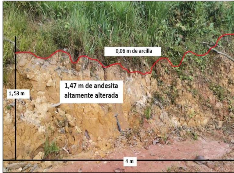
El afloramiento se encuentra completamente húmedo y cubierto por una capa de arcilla de color café claro. En cuanto a su litología, en la corona se observa una capa de arcilla con un espesor de 0,06 m, justo debajo de esta capa, se encuentra una capa de andesita altamente alterada de textura afanítica, de consistencia blanda y porosa susceptible a la disgregación por acción de agua y temperatura con un espesor de 1.47 m.
