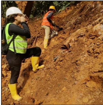
En este sentido, también se efectuó la ejecución de calicatas con el fin de visualizar la continuidad geológica. Se tomó datos de coordenadas de ubicación, dimensiones (ancho, largo profundidad) y descripción de la columna estratigráfica.
