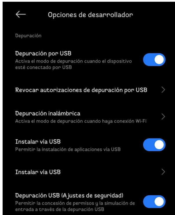
Figura 22. Activación de la depuración por USB e instalación vía USB
