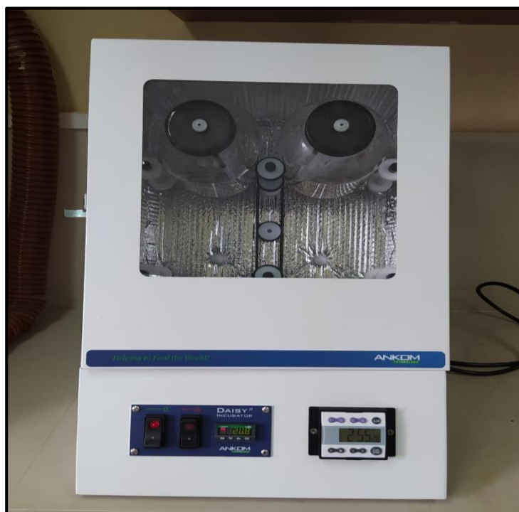
Anexo 11. Equipo ANKOM Daisy II para la determinación de lignina ácida detergente
