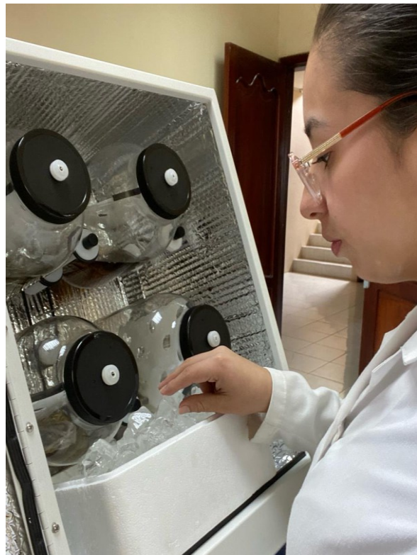
Anexo 6. Análisis de lignina detergente ácida, utilizando el equipo ANKOM DaisyII Incubator.
